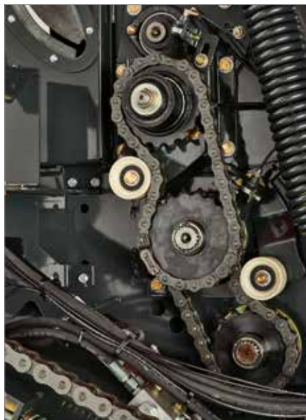
1. Второй ведомый ролик обеспечивает надежный ременный привод при любом состоянии кормовых культур.
