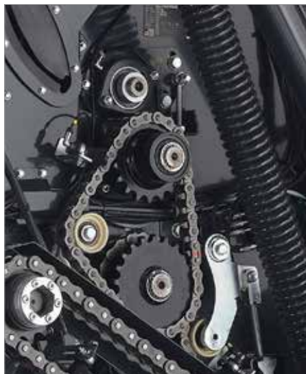
1. Второй ведомый ролик обеспечивает надежный ременный привод при любом состоянии кормовых культур.
