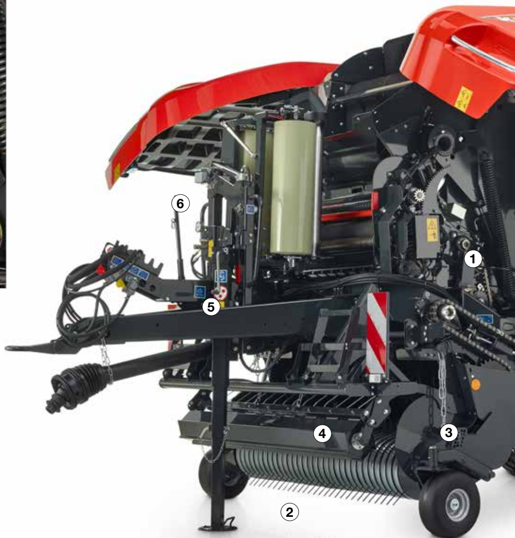
1. Второй ведомый ролик обеспечивает надежный ременный привод при любом состоянии кормовых культур.
