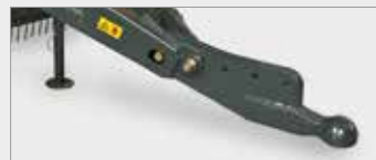
Несколько вариантов исполнения сцепного устройства, включая шаровое сцепное устройство
