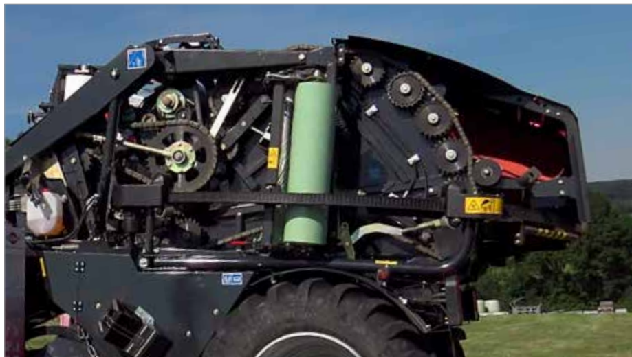
1. Надежный привод с использованием высококачественных цепей IWIS
