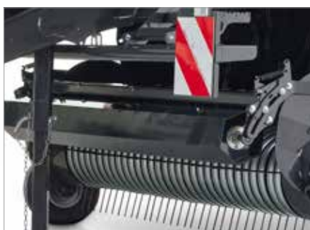
5. Усиленный ролик для обработки культуры с ветровым щитом (Ø 217 мм)
