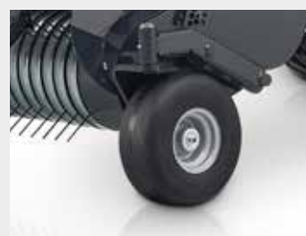
Полупневматические поворотные направляющие колеса
