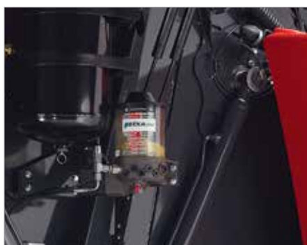
10. Автоматическая система консистентной смазки
